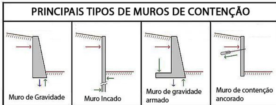
Figura 3: Esquema dos principais tipos de muros de contenção.
