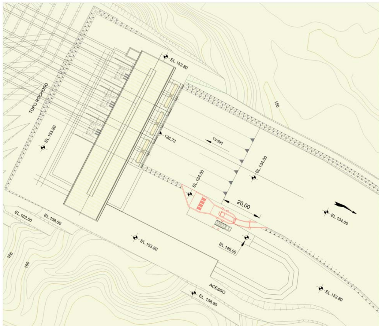
FIGURA 2.1 PLANTA CHAVE DA LOCALIZAÇÃO DO SISTEMA DE CAPTURA E TRANSPORTE DE PEIXES NO CANAL DE FUGA EM SIMPLÍCIO
