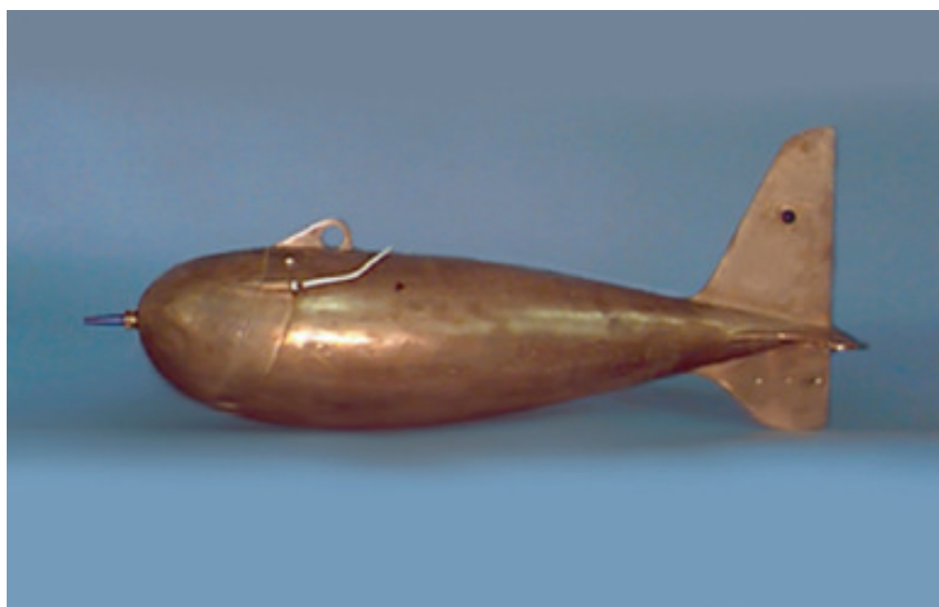
Figura 7.2 - Amostrador pontual integrador US P-61-A1 (DAVIS, 2005)
