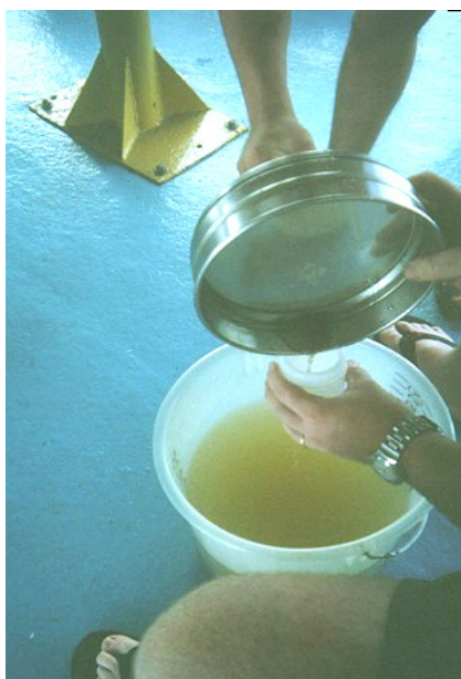
Figura 7.6 - Peneiramento (malha de 62 \mu m) para separar as areias do material fino (silte e argila)
