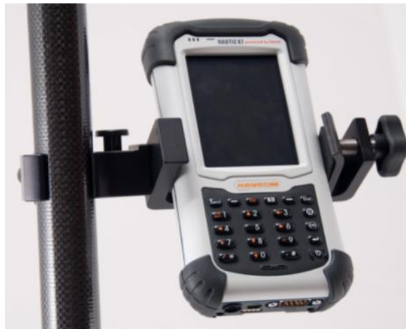
Figura 9 - Nautiz X7 PDA de interface com GPS. Fonte: Manual Técnico Land-Pak NavCom Technology.
