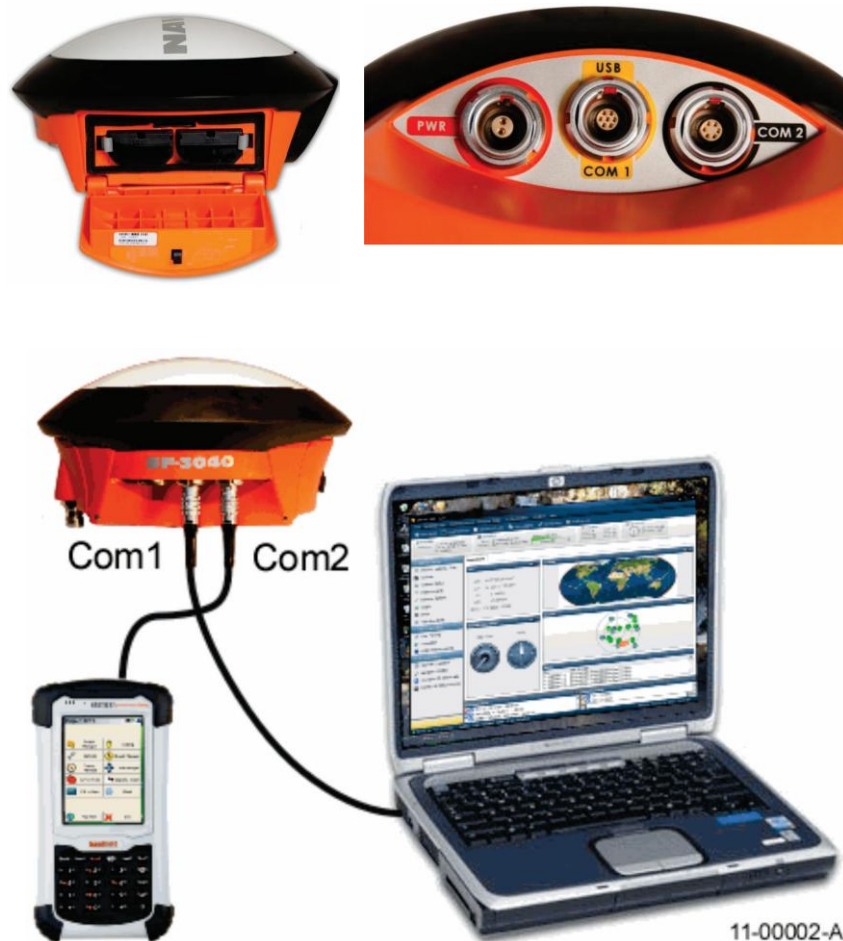
Figura 5 - Características técnicas do receptor GNSS NavCom SF 3040. Fonte: Manual Técnico Land-Pak NavCom Technology.
