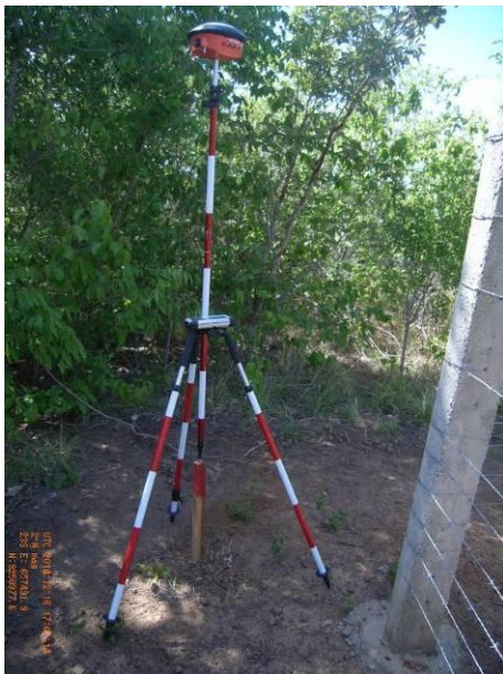
Foto 23 - Vista geral da Área 02 com detalhes para o equipamento utilizado para demarcação e georreferenciamento da área em recuperação.
