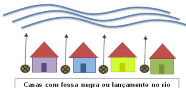
FIGURA 5.1.9.2- 2 – Sistema de esgotamento sanitário existente em Altamira
