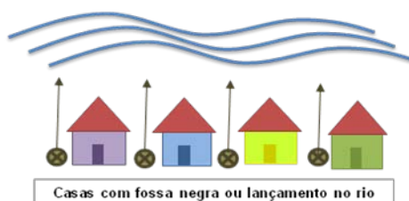
FIGURA 5.2.19.2- 2- Sistema de esgotamento sanitário existente em Vitória do Xingu
