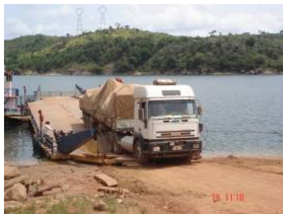
FIGURA 5.3.2.3- 2 – Peso da carreta acentua degrau entra a rampa da balsa e a superfície da rodovia
