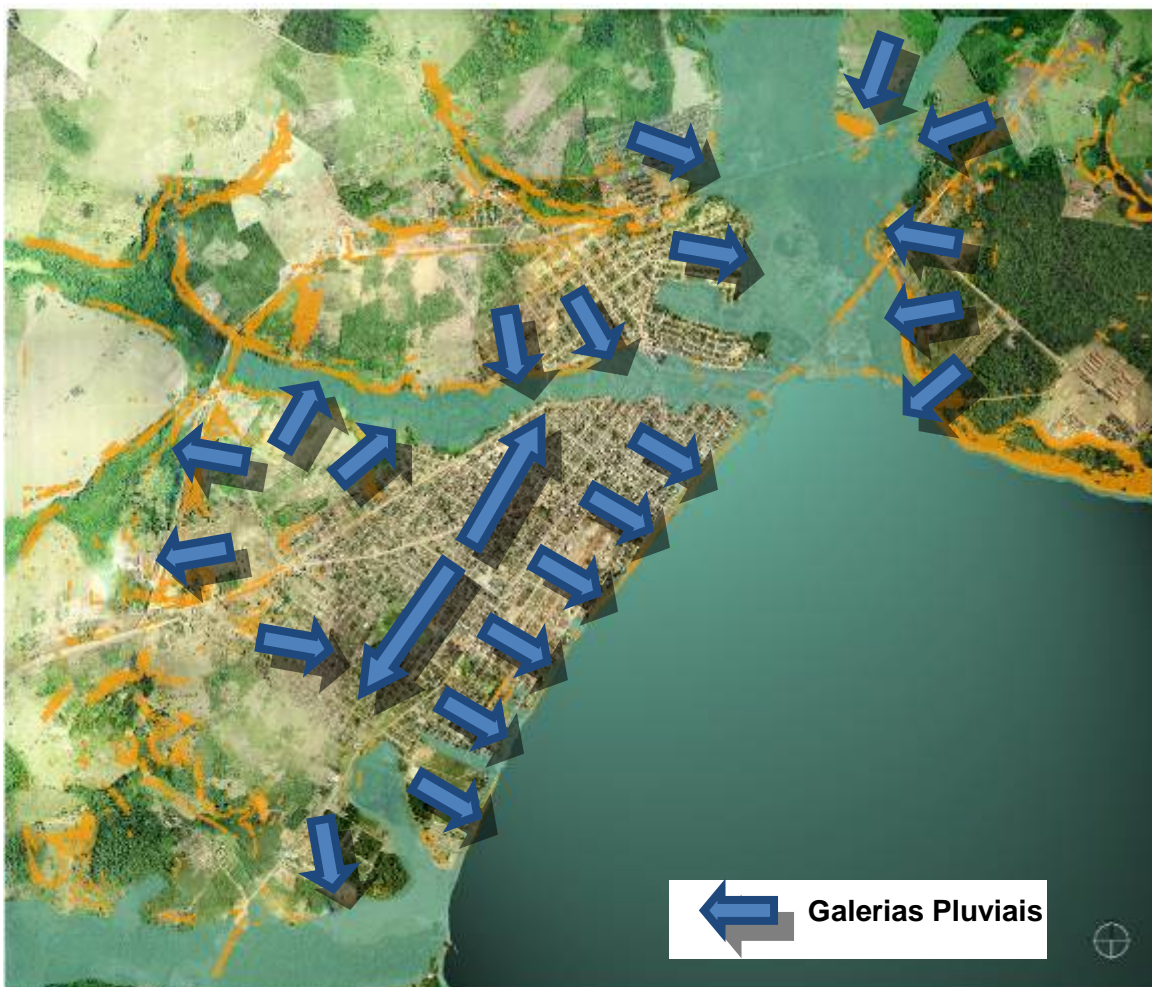
FIGURA 5.1.6.9- 5 - Conceito do sistema de drenagem em Altamira
