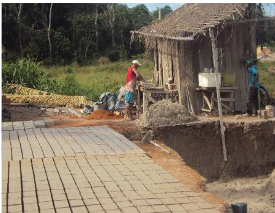
FIGURA 4.5.2-2 - Fabricação artesanal de tijolos na área Sindoalta 1
