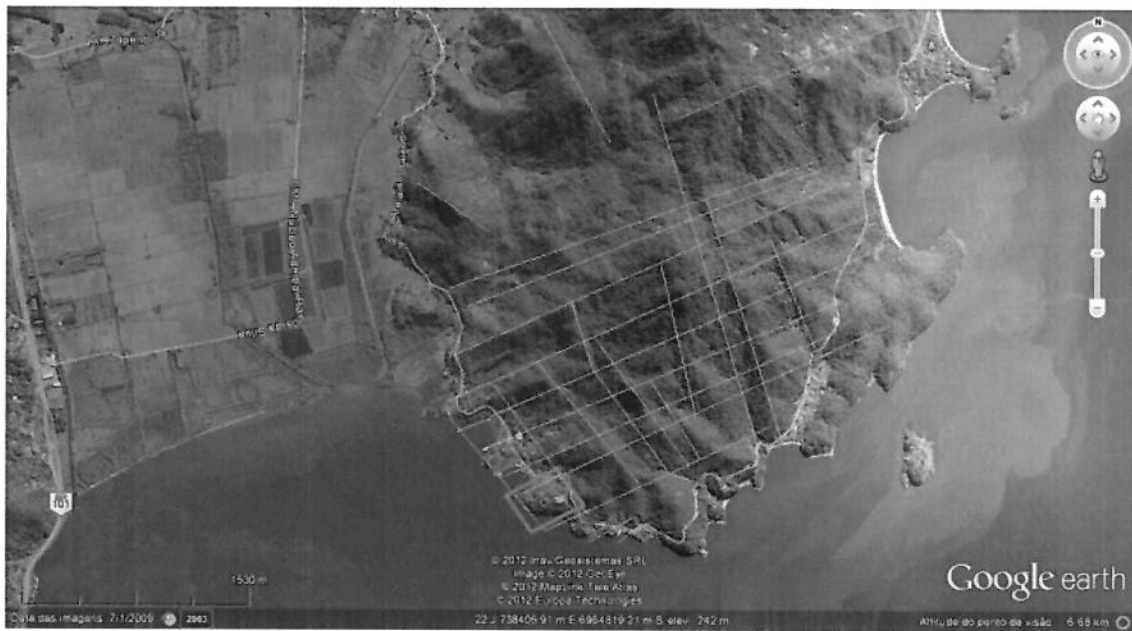
Figura 1. O polígono em vermelho mostra a localização da área. As linha amarelas mostram as duas direções de falhamentos que quebram o maciço rochoso em blocos prismáticos curtos.
