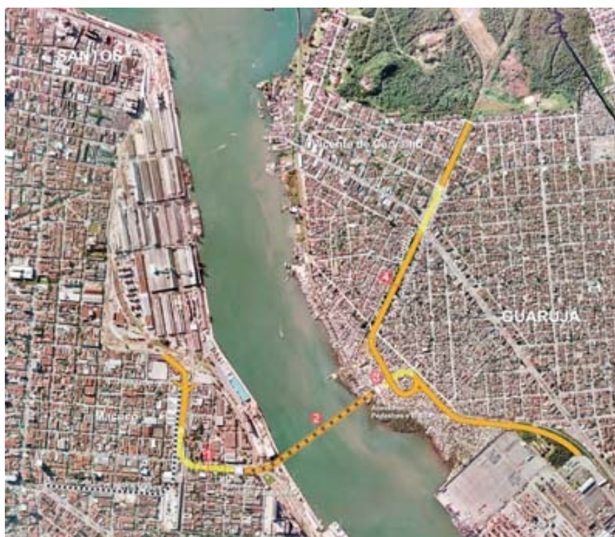
Figura 5.2-1: Ilustração do esquema do túnel imerso de ligação entre Santos e Guarujá. DERSA Desenvolvimento Rodoviário S.A., 2012.
