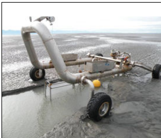
Figura III-13 - Carrinho de jateamento ( jetting sledge )
