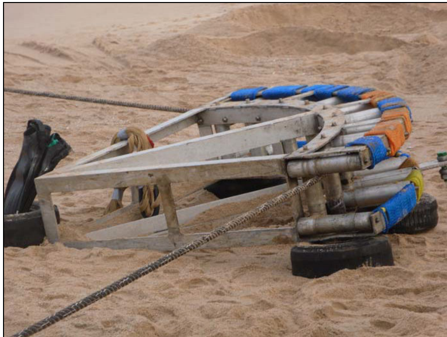
Figura III-14 - Exemplo de quadrante na praia - usado para executar o tracionamento do cabo ao longo da praia.
