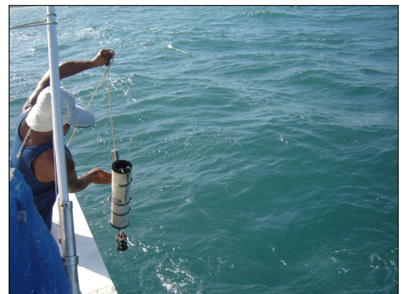
Figura 12 - Garrafa amostradora de "Van Dorn" utilizada para as coletas das amostras de meio e fundo.
