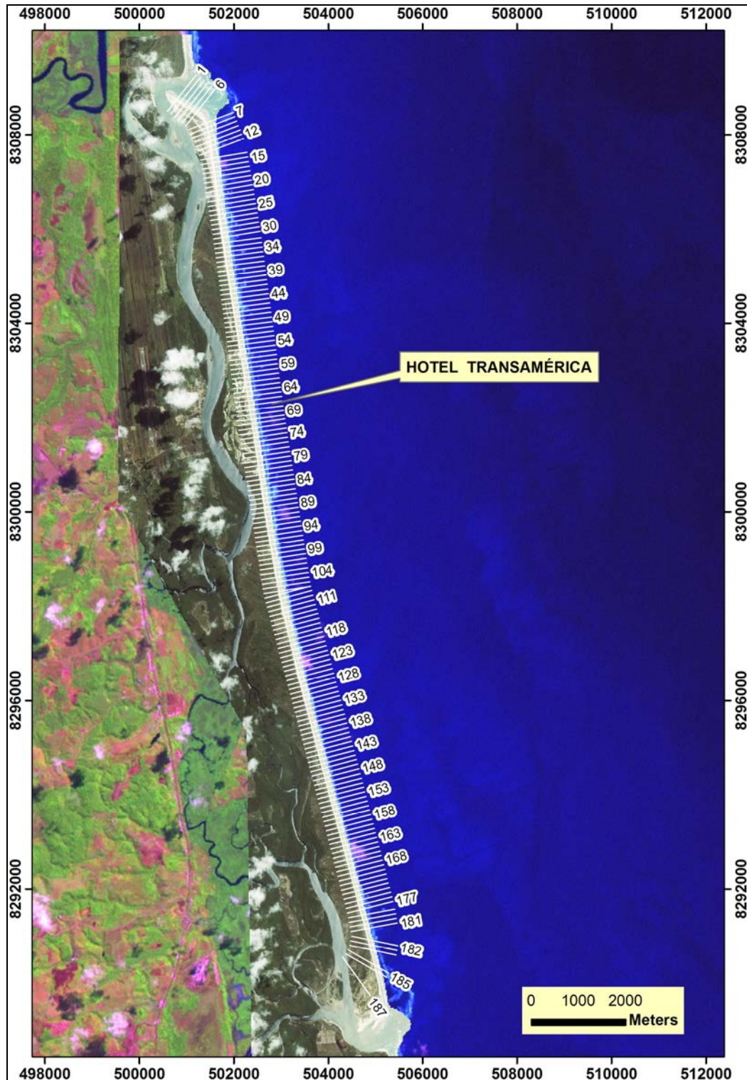
FIGURA 8.2.2-25 – Localização dos 187 transectos perpendiculares à linha de costa, e espaçados de 100 m, onde foram medidos os deslocamentos da linha de costa nos últimos 34 anos (1974-2008).
