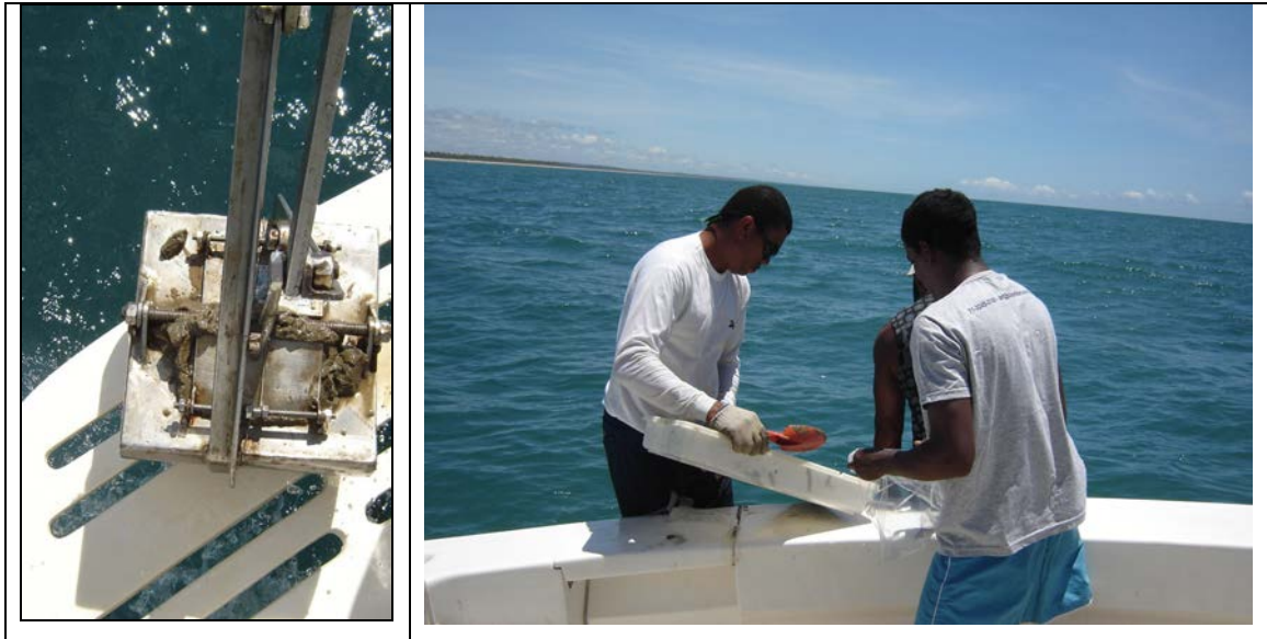
FIGURA 8.3.1-3 – Draga de Van Veen (à esquerda) utilizada para a coleta das amostras de zoobentos (à direita).
