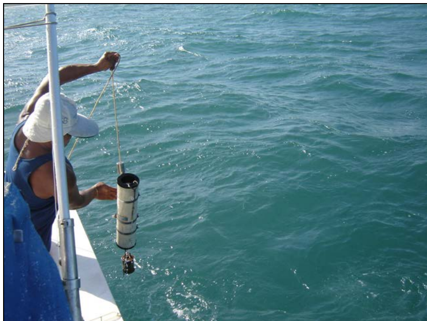
FIGURA 8.2.3-4 – Garrafa amostradora de “Van Dorn” utilizada para as coletas das amostras de meio e fundo
