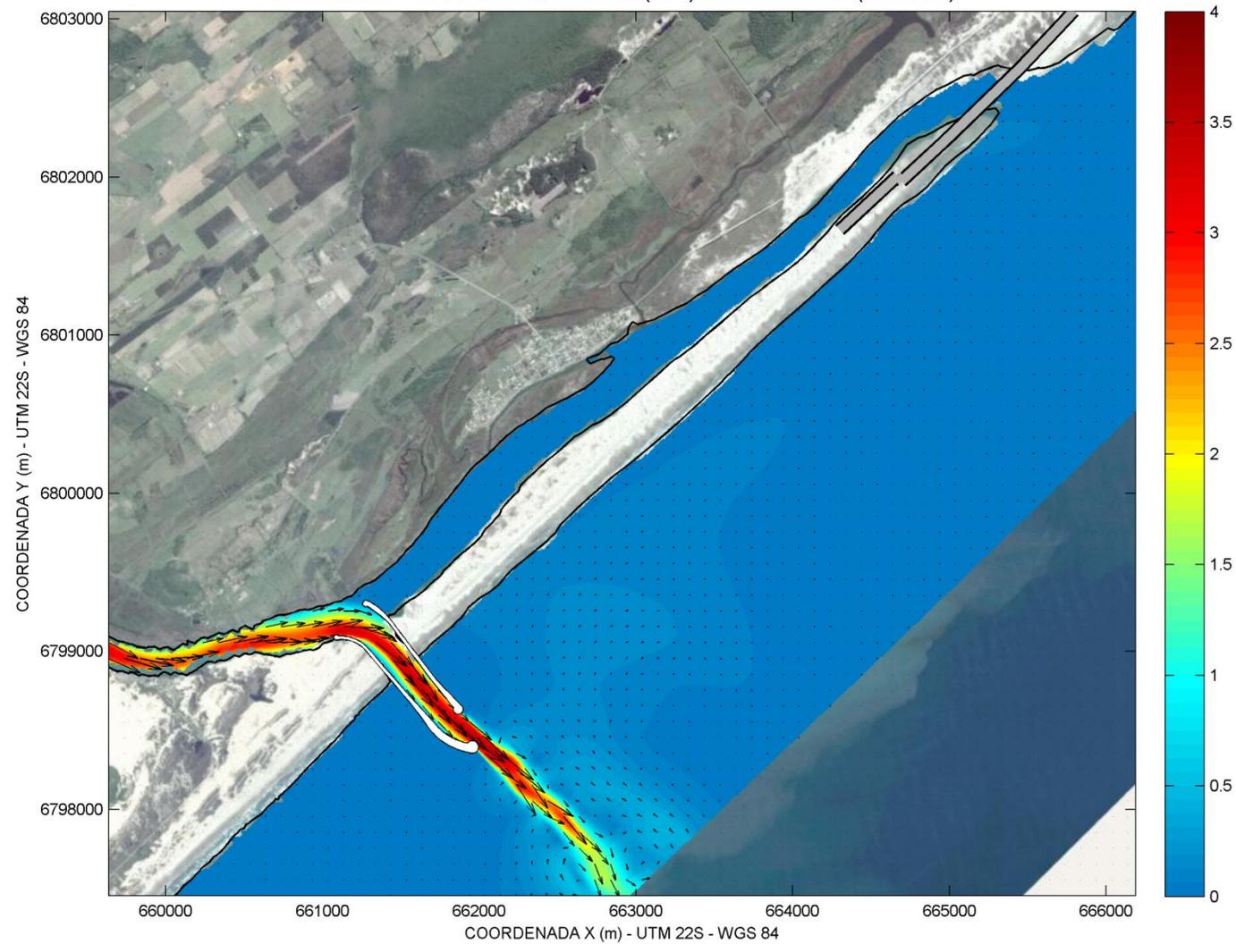
Figura 7: Velocidade de correntes no pico máximo de velocidade durante a simulação da Alternativa 1 (fechada).
