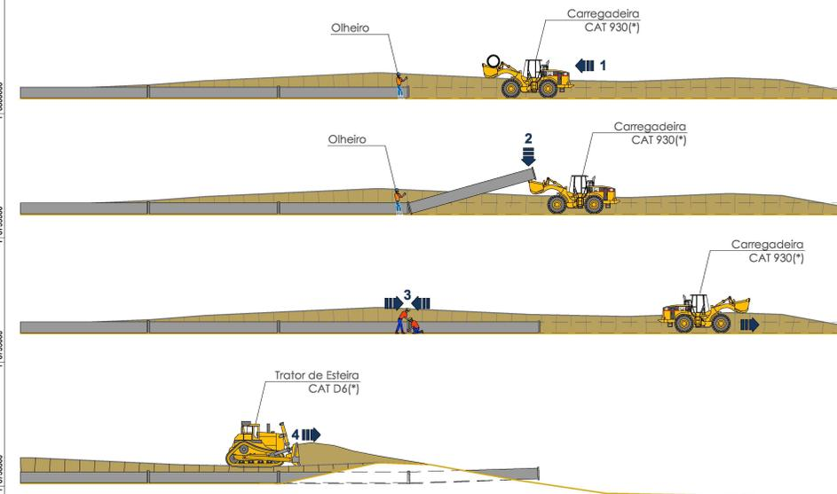
TRAMO DE LINHA TERRESTRE | SEÇÃO ESQUEMÁTICA "PL1"
