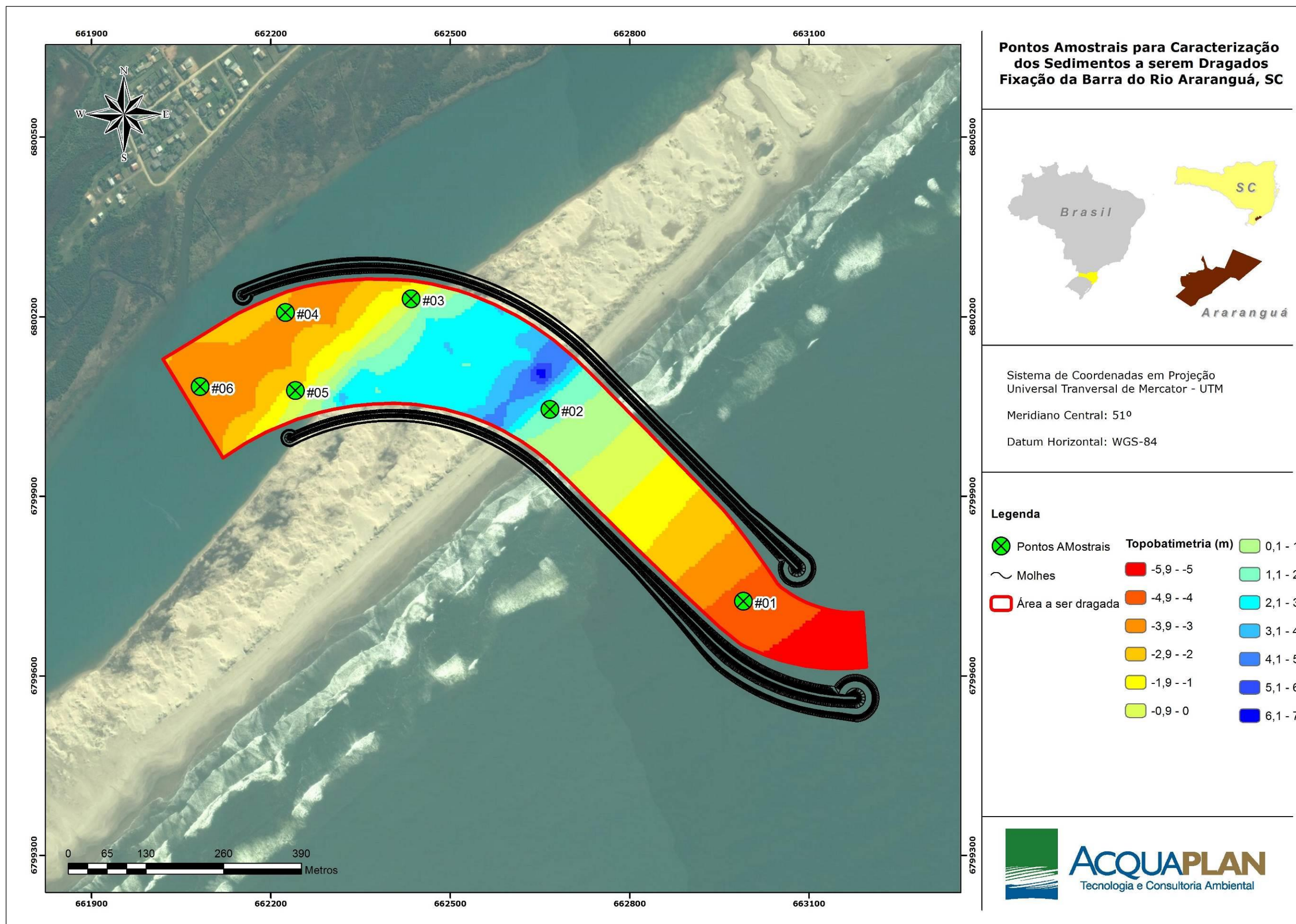
Figura 3. Localizando dos pontos amostrais para caracterização dos sedimentos a serem dragados para fixação da barra do rio Araranguá.
