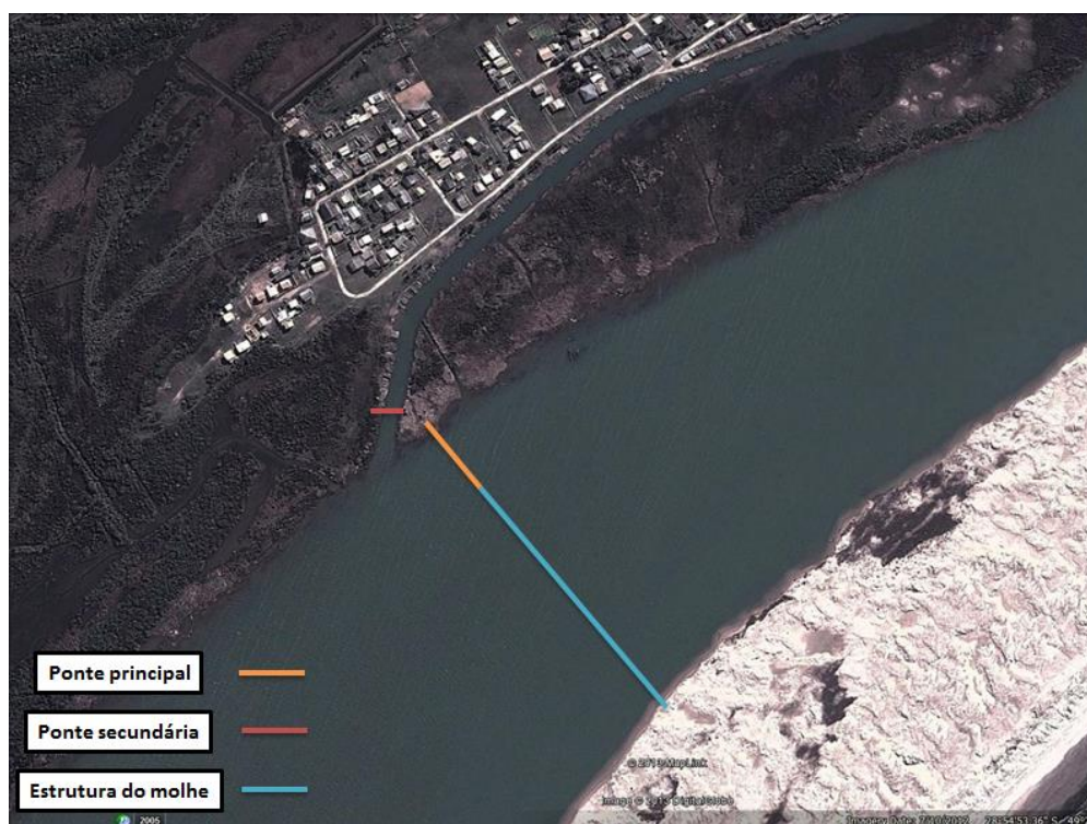
Figura 13. Esquema de estruturas analisadas: Ponte principal (80 m de vão) e ponte secundária (20 m de vão).
