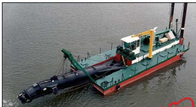
Figura 3: Dragagem de sucção e recalque.
