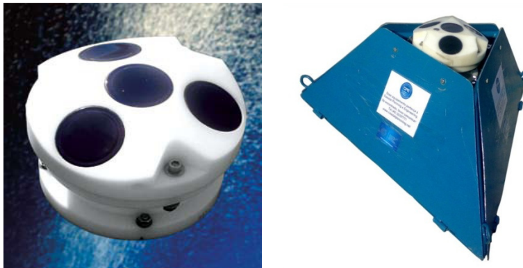
Figura 3. Perfilador de correntes (AWAC®) e CTD utilizado na aquisição dos dados (painel esquerdo) e estrutura de fixação (painel direito).
