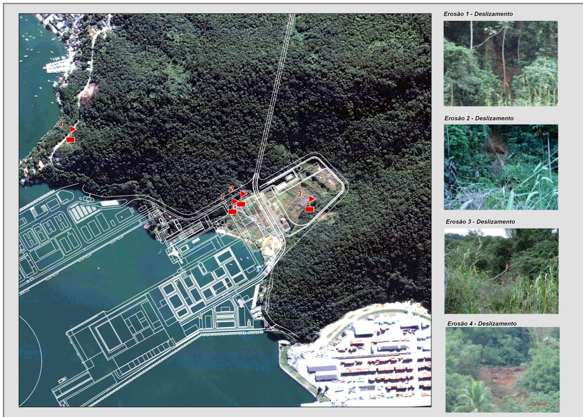
Figura 2 – Feições erosivas pré-existent na área do empreendimento.
