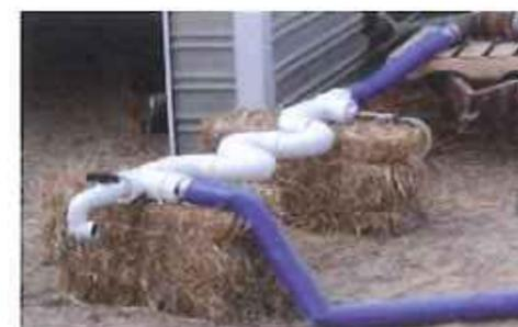
g) No caso de tubulação em zig-zag, deverá ser instalado, no término da mesma, um ponto coletor com válvula e linha de retorno para permitir amostragem de material, para verificação do processo de floculação, otimizando a dosagem de polímeros, sem perda de eficiência do sistema.
