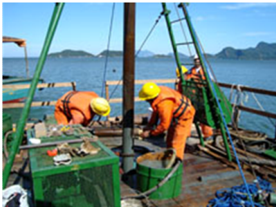
Figura 5.1-234 - Procedimento de limpeza da tubulação de manobra após a realização da amostragem em um ponto.
