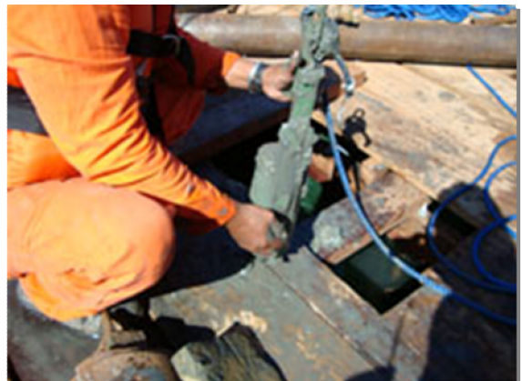
Figura 5.1-235 - Amostra de topo onde se observa a argila cinza existente na porção superior do leito da área em estudo.
