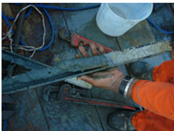
Figura 5.1-236 - Amostra de meio de perfil de um ponto na bacia de evolução do empreendimento onde se observa a transição de argila arenosa para areia argilosa com fragmentos de conchas.
