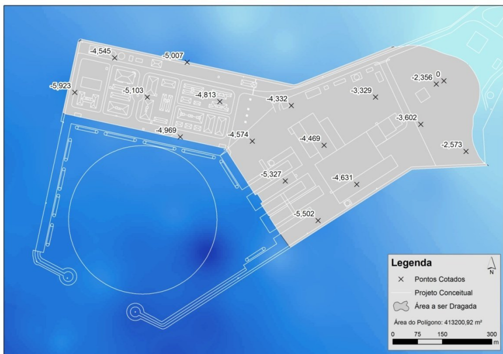
Figura 5.1-211 – Área a ser dragada para retirada de lama do fundo.
