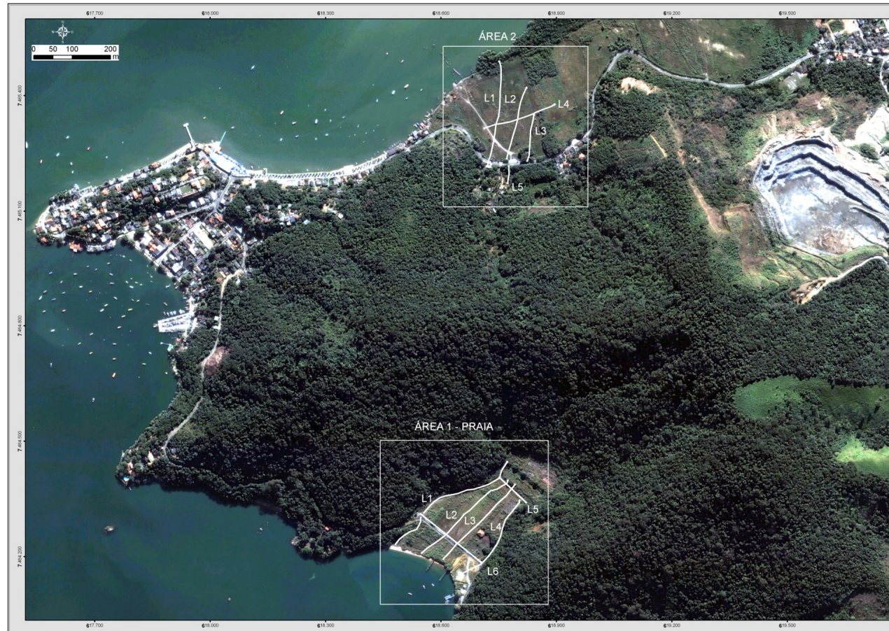
Figura 5.1-104 - Imagem Quick Bird com a localização das áreas de estudo e das linhas de levantamento geofísico.
