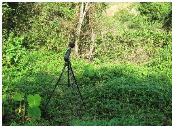
Figura 5.1-163 – Ponto 5 de medição de ruído de fundo
