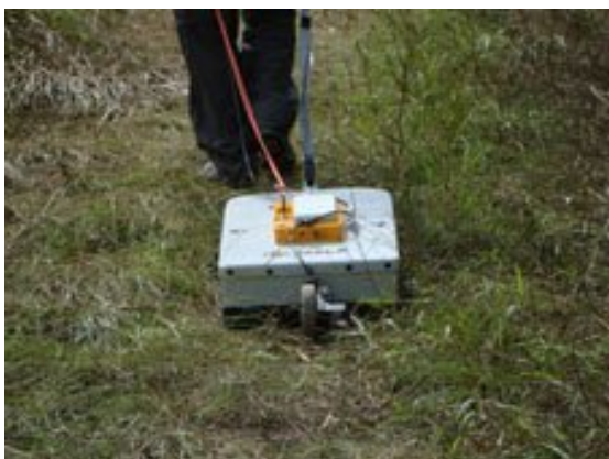
Figura 5.1-109 - Detalhe do Georradar.
