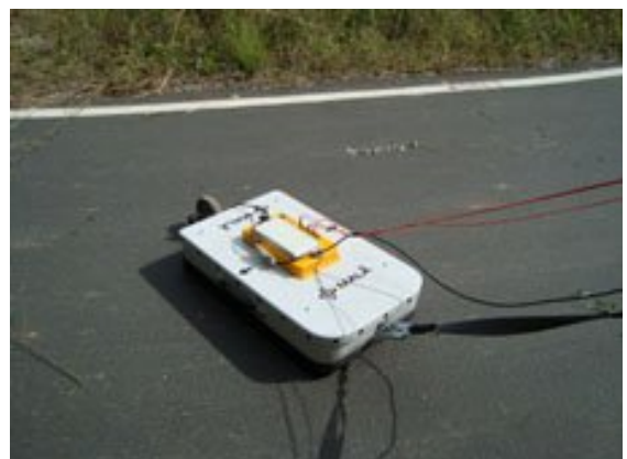
Figura 5.1-110 - Detalhe do Georradar.
