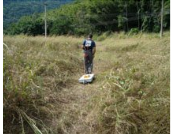
Figura 5.1-106 - Caminhamento para perfilagem geofísica.
