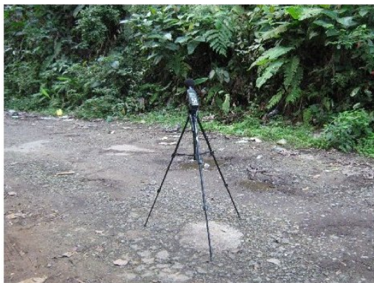
Figura 5.1-171 – Ponto 8 de medição de ruído de fundo
