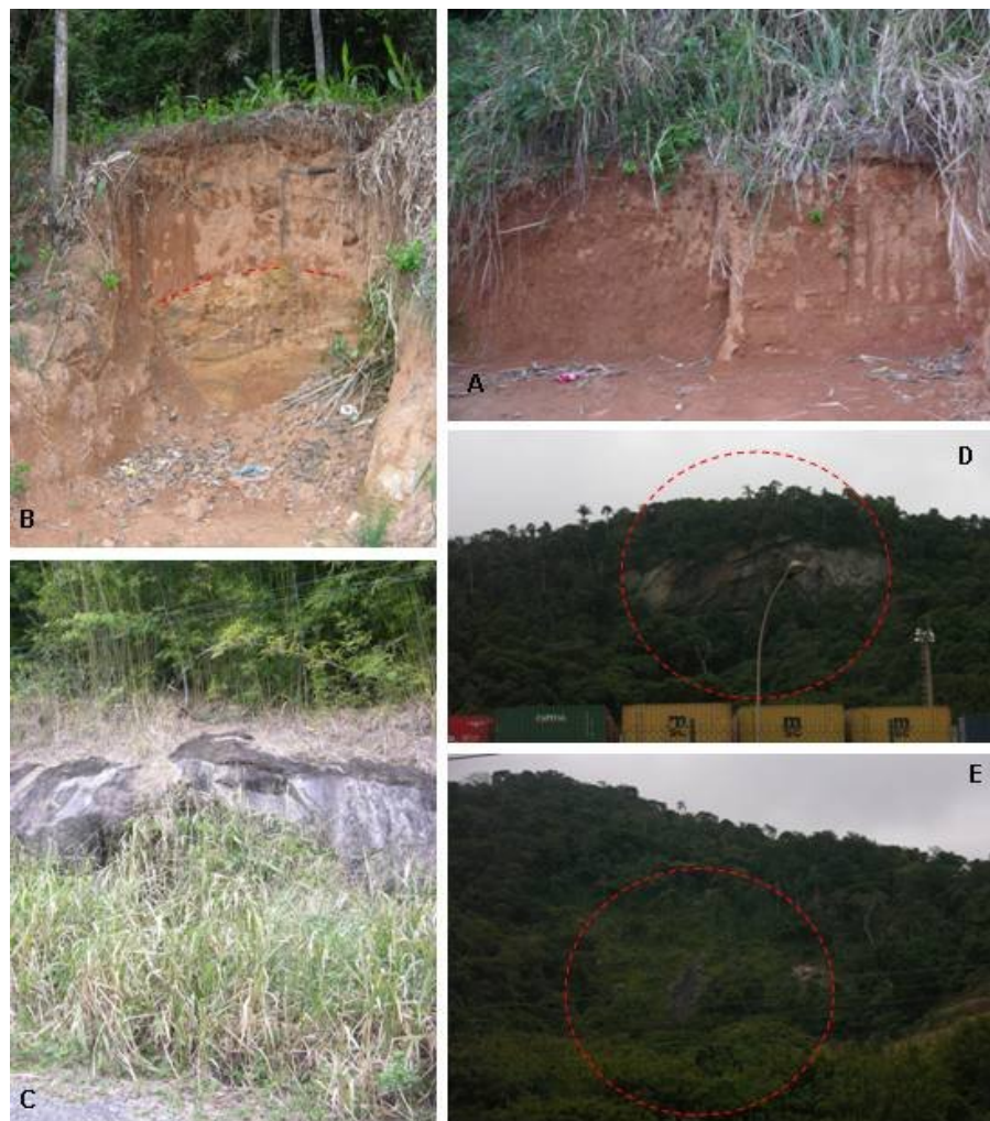
Figura 5.1-84 - Cambissolos em áreas de altas altitudes na Estrada José Miranda Oliveira (A); Cambissolo sobre saprolito (B); Litossolos com cobertura vegetal não original (C); Afloramentos rochosos sem e com cobertura vegetal (respectivamente D e E).
