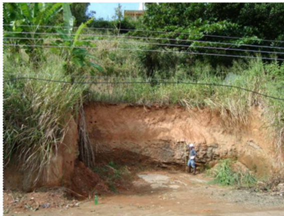
Figura 5.1-87 - Solos coluvionares que ocorrem no norte da Ilha da Madeira. Composição argilo-arenoso, de coloração amarelada a avermelhada, espesso e com boa plasticidade. Ocorre rocha sã na base.
