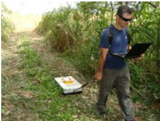
Figura 5.1-107 - Caminhamento para perfilagem geofísica.
