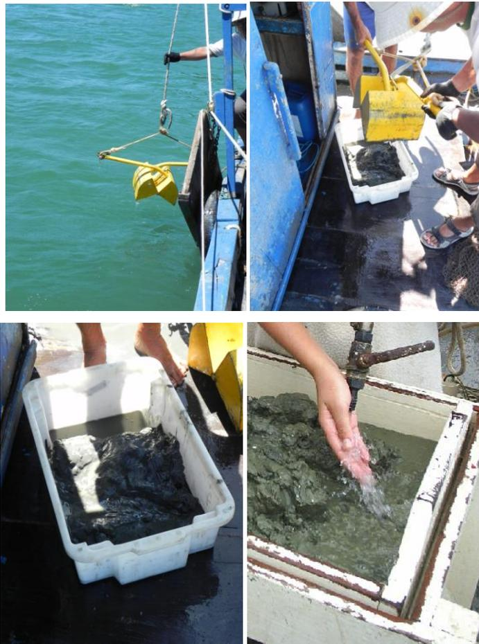
Figura 57. Lançamento de *van-Veen* para coleta do sedimento para análise da comunidade bentônica e lavagem sedimento.
