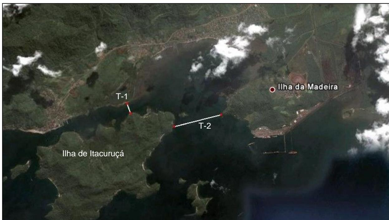
Figura 6: posição dos 2 transectos para medição do ADCP embarcado (Google Earth)
