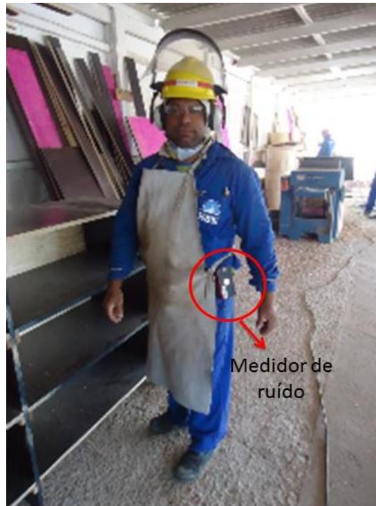
Figura 1 – Exemplo de colaborador portando medidor de ruído durante a jornada de trabalho.
