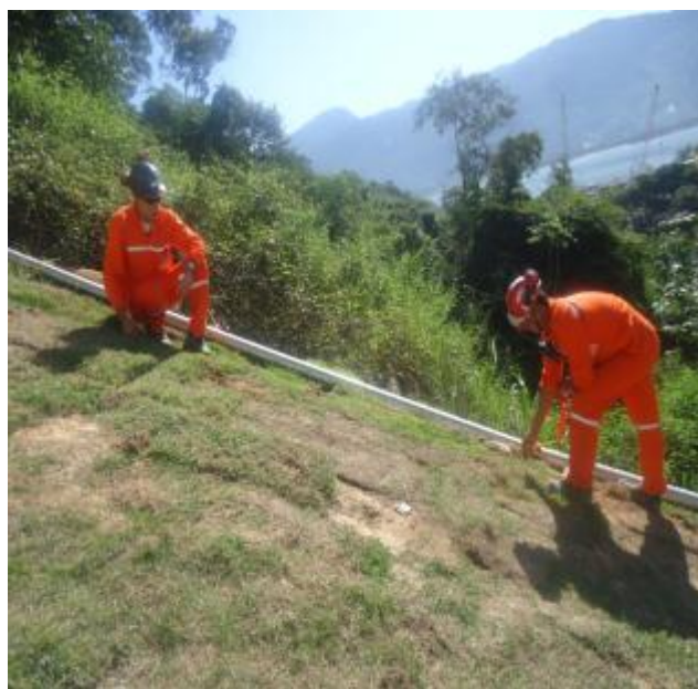
Figura 35 – Detalhe da rachadura no solo e equipes realizando o monitoramento com medição da Feição Erosiva 14 em Julho de 2012.
