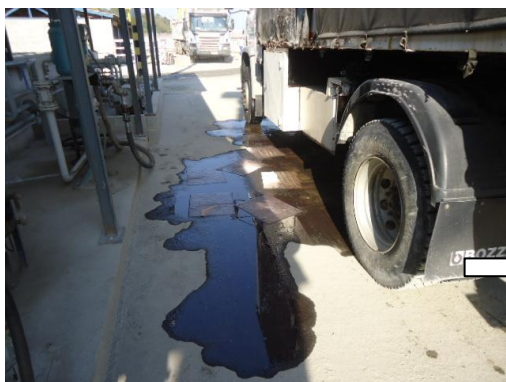
Figura 41 – Vazamento de produto químico.
