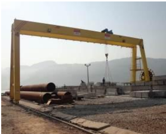
Figura 12 - Pontes suspensas para transporte de pré-moldados.
