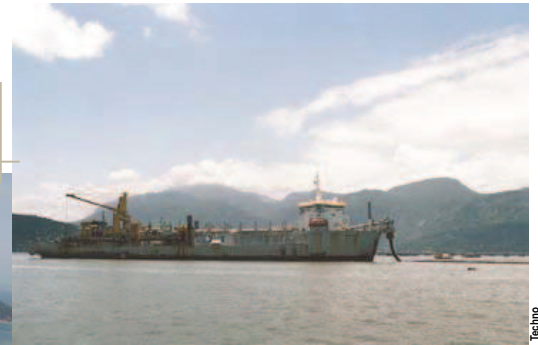
Abaixo, vista aérea das unidades de Geotube, onde estão retidos os sedimentos contaminados; ao lado, draga utilizada no processo de retirada dos sedimentos da baía de Sepetiba
