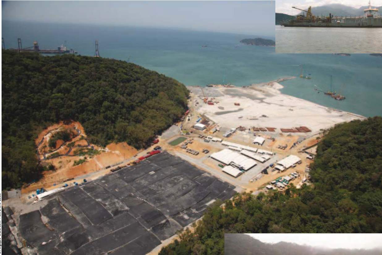
Abaixo, vista aérea das unidades de Geotube, onde estão retidos os sedimentos contaminados; ao lado, draga utilizada no processo de retirada dos sedimentos da baía de Sepetiba
