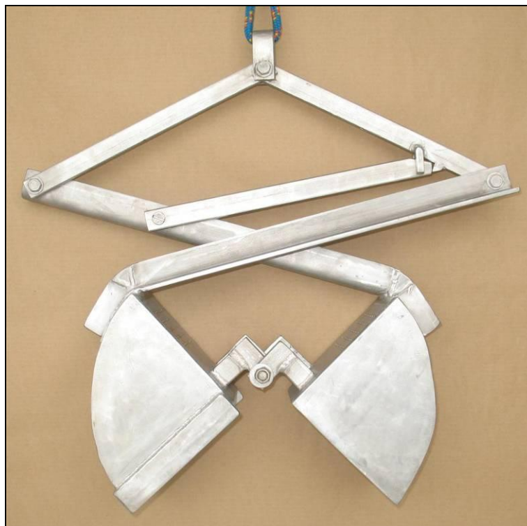
Figura 4. Ilustração da draga modelo van Veen utilizada para a coleta de amostras de sedimento superficial.
