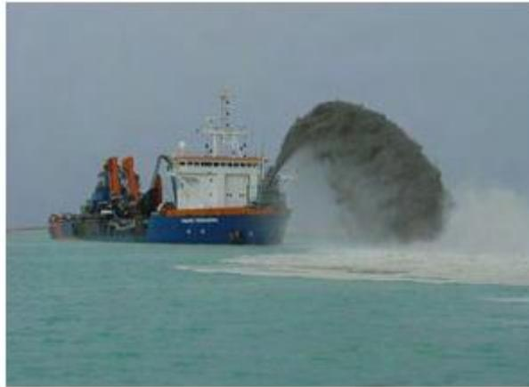
Figura 38. Sistema de descarga em arco-íris (VAN OORD, 2013).
