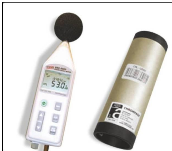
Figura 18. Medidor de nível de pressão sonora (decibelímetro) e calibrador de nível sonoro marca Instrutherm, modelo CAL – 3000
