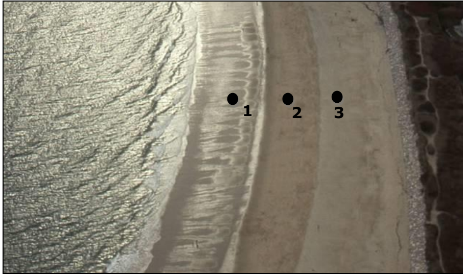
Figura 84. Representação dos perfis a serem realizados em cada um dos pontos amostrais na praia.
