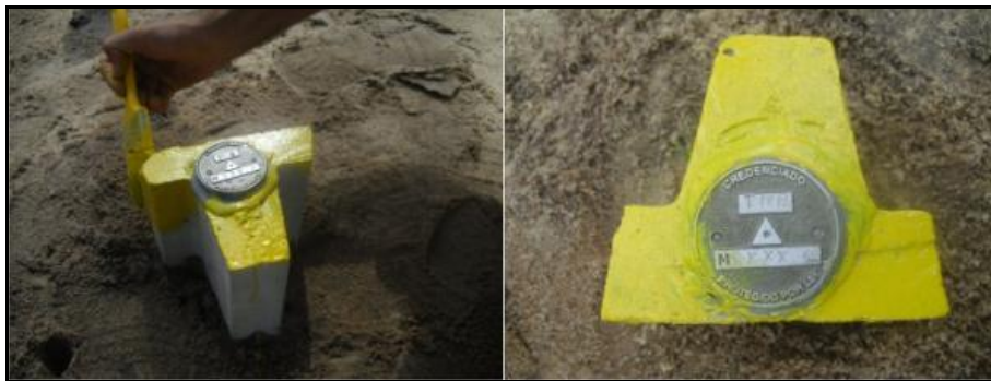
Figura 46. Novos marcos a serem estabelecidos, constituídos por concreto, pintados de tinta amarela e identificados com placa metálica de identificação.
