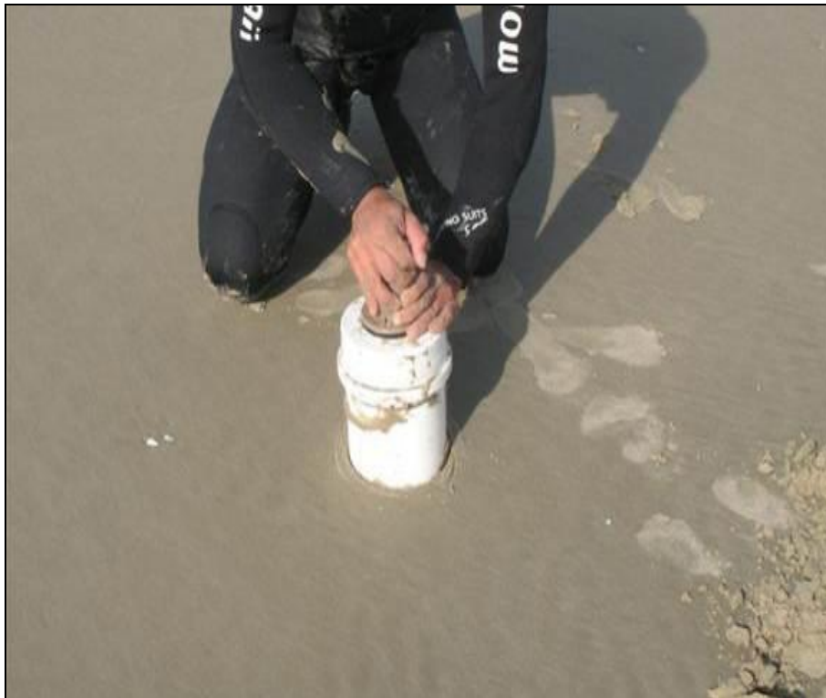
Figura 85. Amostrador de PVC (15 x 15 cm) utilizado na praia arenosa.
