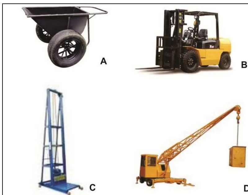
Figura 6. Formas de transporte de resíduos da construção civil: A – girica, B – bobcat , C– elevador de cargas e D – grua.
