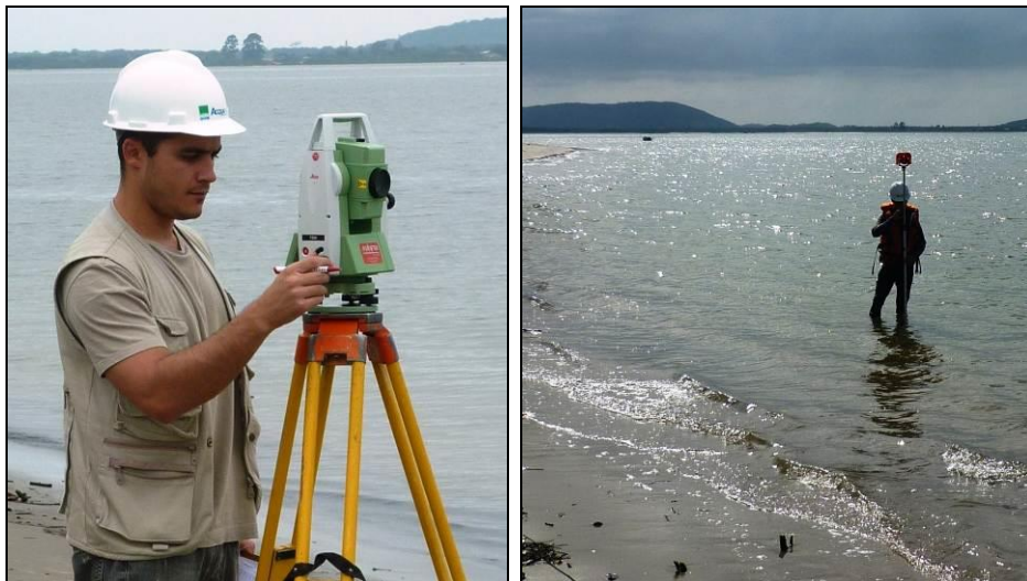
Figura 49. Levantamento de perfil praial realizado através de levantamentos topográficos perpendiculares à linha de costa. A figura à esquerda apresenta o operador da Estação Total, enquanto que, à direita, uma segunda pessoa opera o bastão com o prisma.
