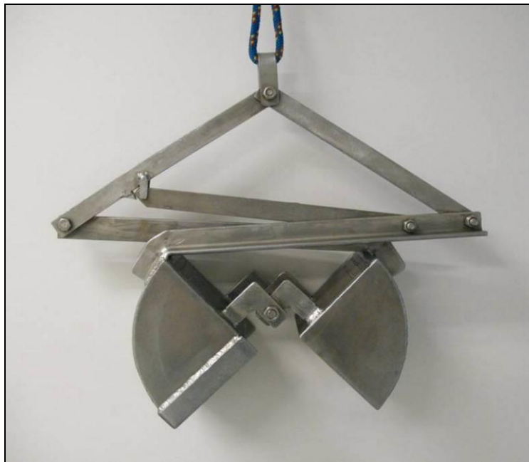
Figura 82. Draga busca fundo do tipo van Veen utilizada para a coleta de amostras da macrofauna bentônica.
