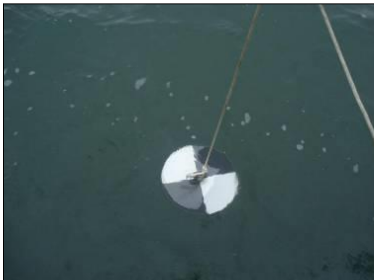
Figura 30. Uso de disco de Secchi para medição de transparência da água.
