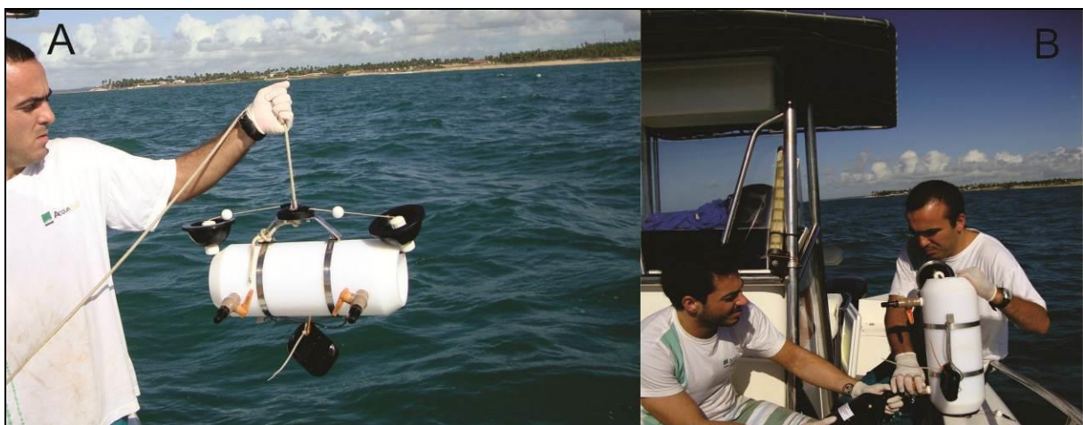
Figura 77. Garrafa amostradora do tipo van Dorn (A); procedimento de coleta de amostra de água a partir do emprego de garrafa amostradora (B).
