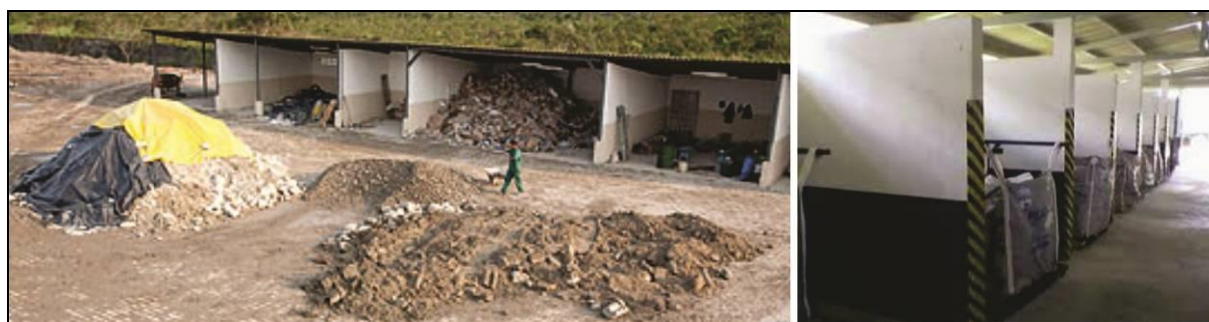
Figura 7. Exemplos de baias que podem ser utilizadas no armazenamento de resíduos resultantes de obras civis.
