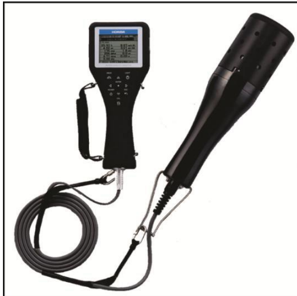
Figura 39. Exemplo de sonda multiparâmetro utilizada para a medição da turbidez da água.
