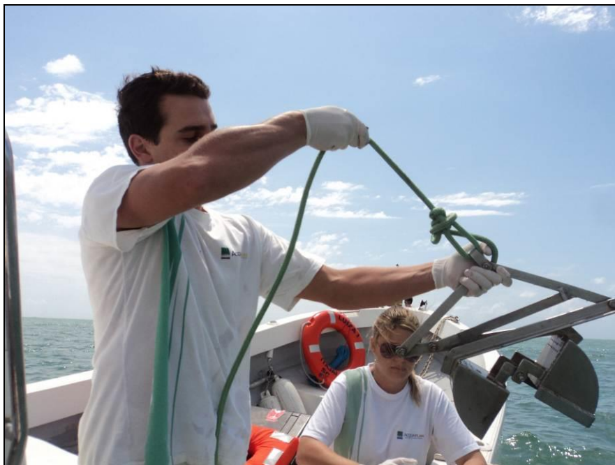
Figura 10. Demonstração do pesquisador utilizando o pegador de fundo para realização da coleta de sedimento.
