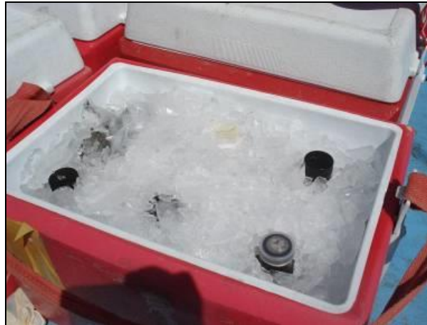
Figura 27. Caixas térmicas utilizadas para armazenamento das amostras de sedimento e água (à direita).
