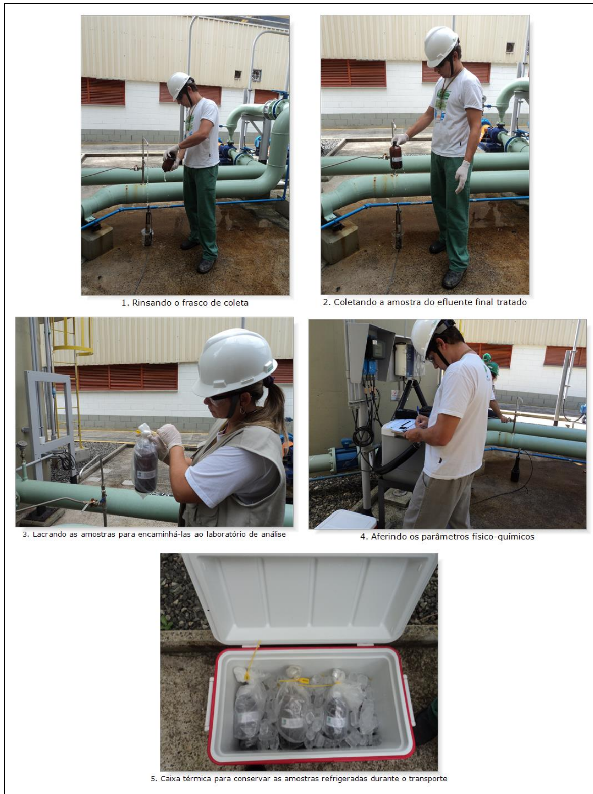
Figura 8. Exemplo de procedimento de coleta de amostras do efluente final tratado: (1) Coletor rinsando o frasco antes de captar a amostra; (2) Coleta de efluente em frasco âmbar; (3) Amostras sendo lacradas para rastreabilidade; (4) Coletor anotando os parâmetros físico-químicos obtidos da leitura da amostra com sonda multiparâmetros e (5) Amostras acondicionadas em caixa térmica com gelo, para resfriamento durante o transporte.
