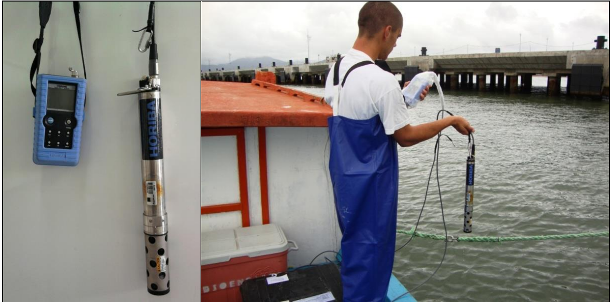
Figura 29. Sonda multiparâmetros Horiba W-22.
