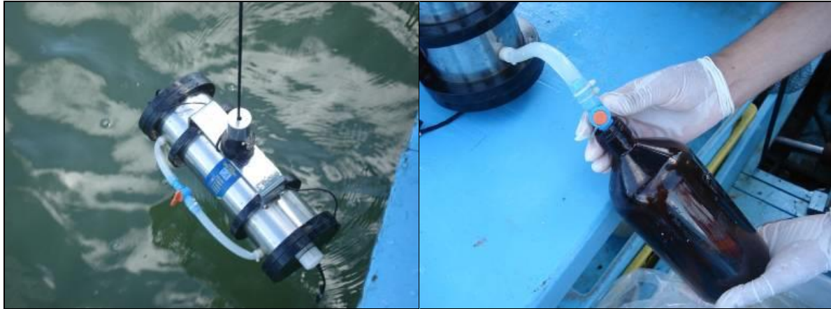
Figura 31. Procedimento de coleta de água através de uma garrafa amostradora do tipo van Dorn (à esquerda). Transferência da amostra de água da garrafa para os frascos de vidro (à direita).
