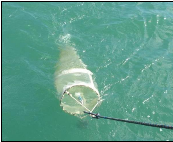
Figura 78. Rede de plâncton com malha de 200 µm de abertura.
