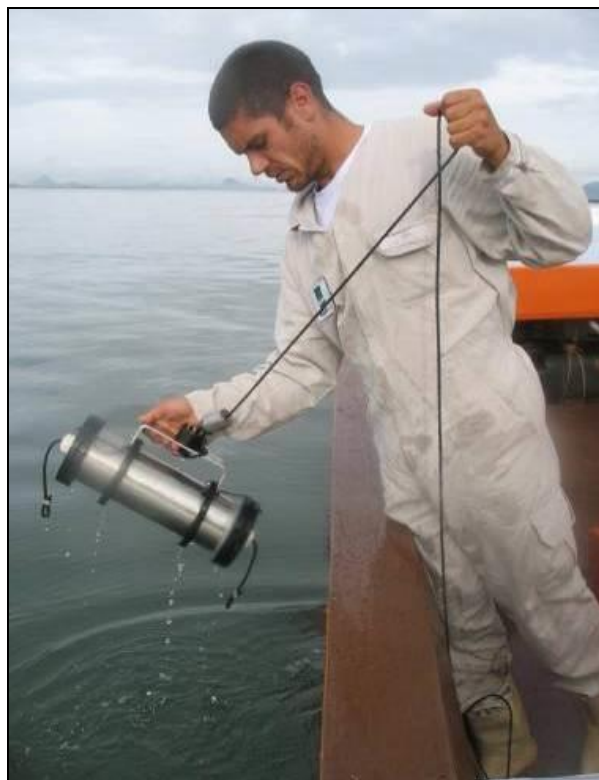
Figura 28. Garrafa amostradora van Dorn utilizada para coleta de água.
