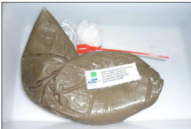
Figura 33. Imagem de uma amostra de sedimento acondicionada logo após a coleta.
