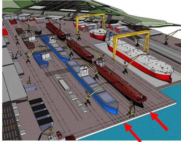
O novo estaleiro possuirá duas linhas de Load Out para a fabricação de navios em série, fornecendo maior flexibilidade e produtividade. Projetada para fabricar navios do tipo SUEZMAX, sua operação se dá através de carros hidráulicos sobre trilhos, que movimentam partes do navio e o transporte do mesmo para um dique flutuante, operação conhecida como Load Out.
