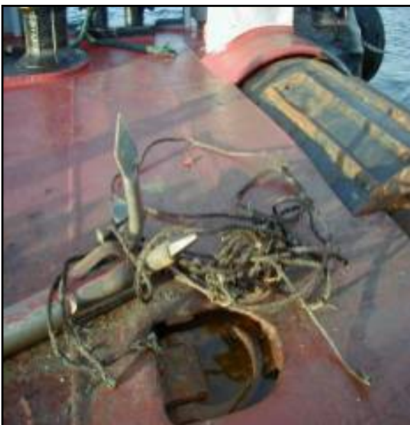
Figura III-31 - Fateixa típica utilizada na remoção de detritos do leito oceânico antes da operação de enterramento do cabo submarino
