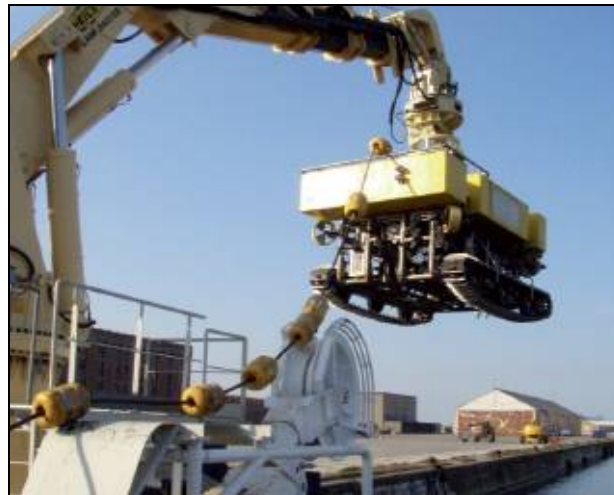
Figura III-13 - Exemplo de ROV utilizado na instalação de cabos submarinos pela ASN.
