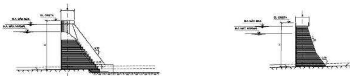
Figura 3.9: Seções típicas do maciço das barragens em CCR
