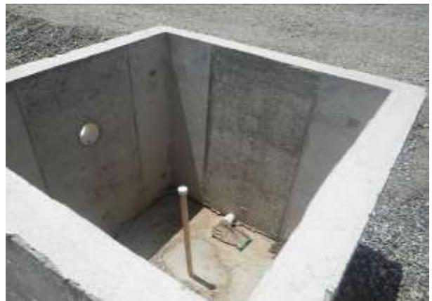
**Figura 15-274 – Piezômetro**
