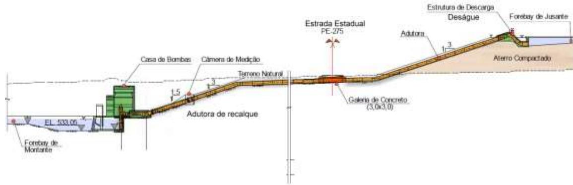
**Figura 4-2** - Ilustração dos limites dos componentes dos subsistemas para identificação de perigo da EBV-6.
