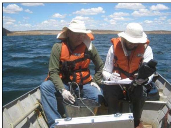
Foto 1.6.2. Estação amostral Q34 – Açude Santa Cruz Obtenção de dados utilizando sonda multiparâmetros
