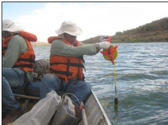
Foto 1.6.6. Estação amostral Q37 – Açude Engenheiro Ávidos. Medição da profundidade.
