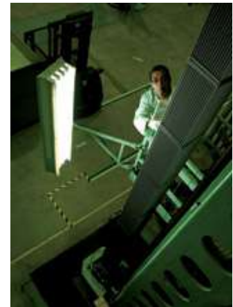
Manuseio das varetas onde ficam armazenadas as pastilhas de urânio enriquecido, que depois irão para as usinas de Angra 1 e Angra 2
