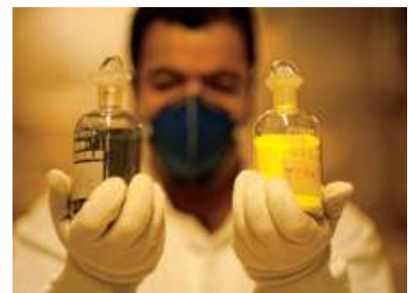
Amostras do minério em diferentes momentos do processo de reconversão: à esquerda, dióxido de urânio. À direita, tricarbonato de amônia e uranila, o TCAU, de cor amarela
