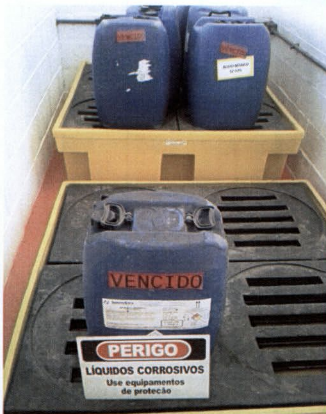
Presença de resíduos no depósito: ácido clorídrico e ácido nítrico (à esquerda) e ácido cítrico (à direita) utilizado na recuperação do urânio antes de ser lançado como efluente.
