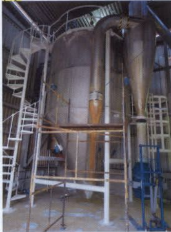
Ilustração 4: Unidade Principal do Spray dryer (2)
