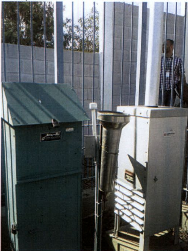
Parâmetros monitorados: partículas em suspensão com HiVol, volume de chuva com pluviógrafo e partículas gama com TLD.
