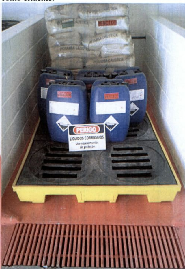
Fosfato de amônio e peróxido de hidrogênio (à esquerda) e potassa cáustica (à direita), utilizado no lavador de gases SAD-03,.
