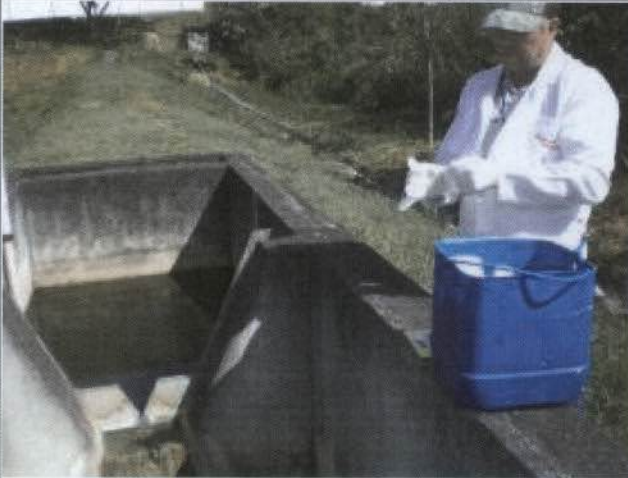
82: Vertedouro com preparação para coleta de amostra
