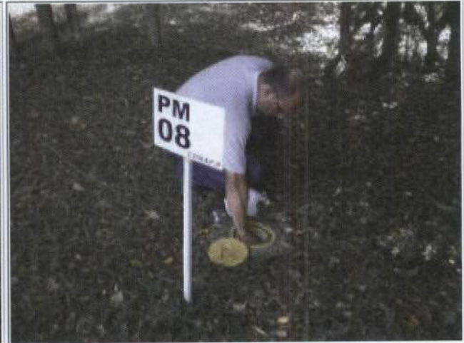
95: Poço de Monitoramento nº 8
