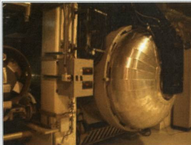
17: Cilindro de UF6 (esq.) e Autoclave (direita)
