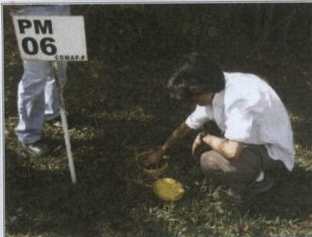
92: Entrada do Poço de Monitoramento nº 6 (tampa amarela)
