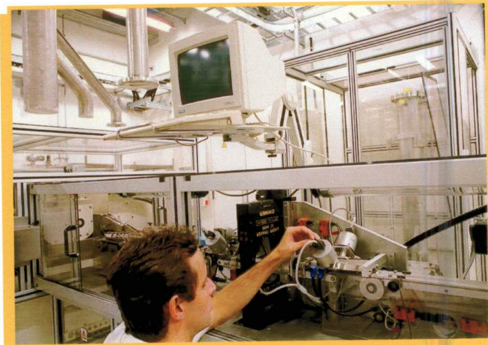
Sistema Laser de Medição da Retífica
