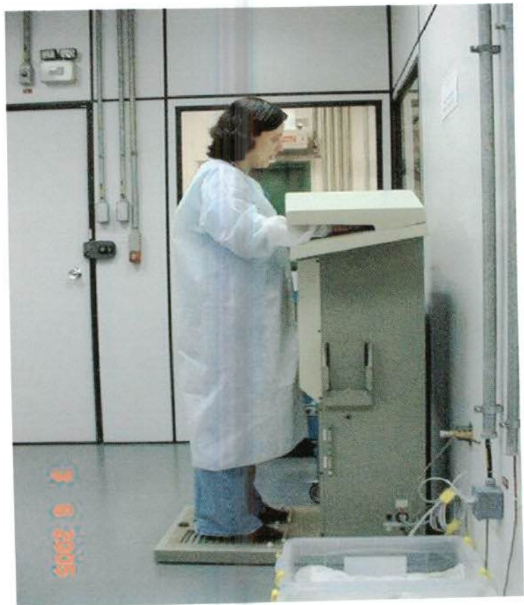
Figura 12: SALA UJE01-101a Radioproteção Medidor de Pés e Mãos
