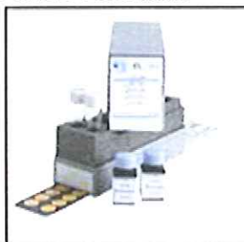
Figura 2 – Kit utilizado para medição de Cloro Residual
