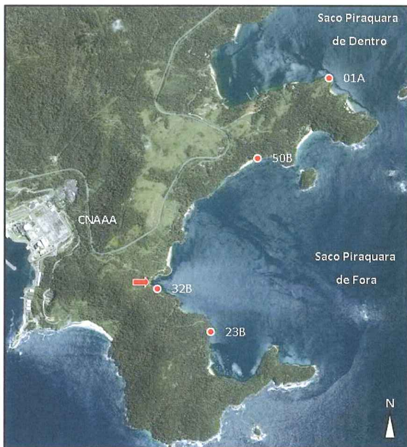
Figura 2 – Pontos de amostragem de fitobentos na área impactada (Saco Piraquara de Fora) e controle (Saco Piraquara de Dentro). Seta vermelha – ponto de lançamento dos efluentes térmicos. CNAAA – Central Nuclear Almirante Álvaro Alberto.
