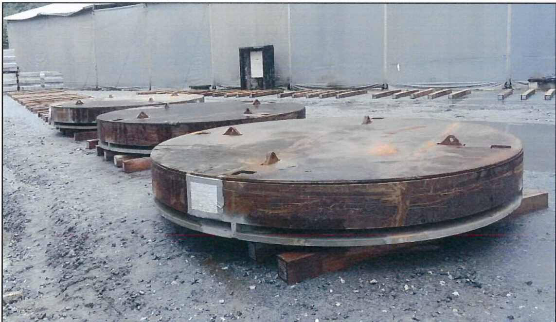
Figura 08: Área preparada para armazenamento das tampas dos tanques Hi Storms.
