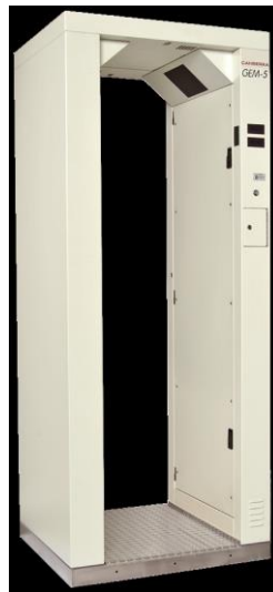
Figura 5 - Foto do portal de monitoração de pessoal da guarita da UAS. Modelo GEM-5, da Mirion Technologies [4].
