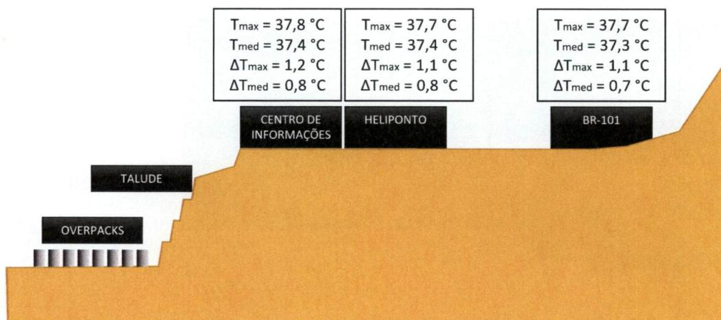
**Fig. 7. Temperaturas máximas e diferenças máximas de temperatura de acordo com o modelo numérico para a condição de vento mais desfavorável.**
