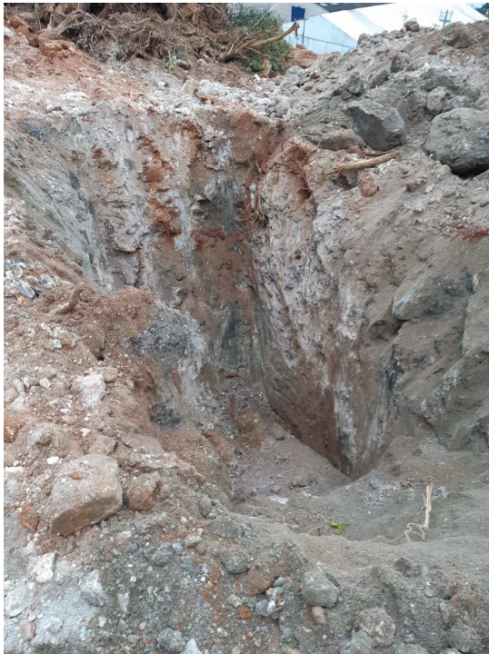
(b) Paredes e fundo da trincheira com solo residual jovem e saprólito
