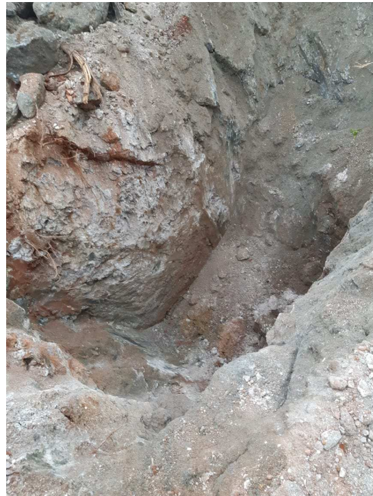
(b) Paredes e fundo da trincheira com solo residual jovem e saprólito
