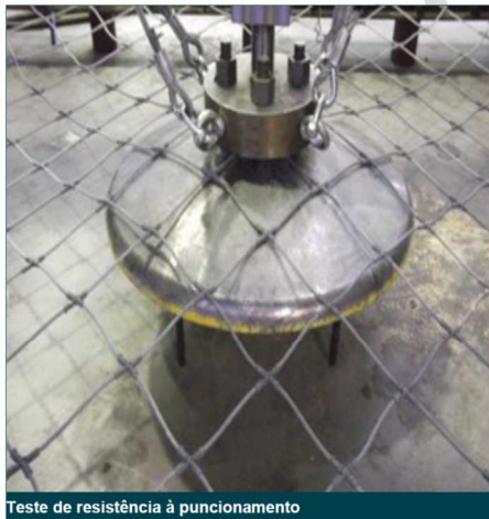
Teste de resistência à punção
