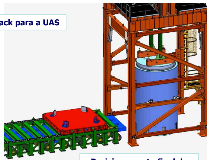
Posicionamento final do Overpack
