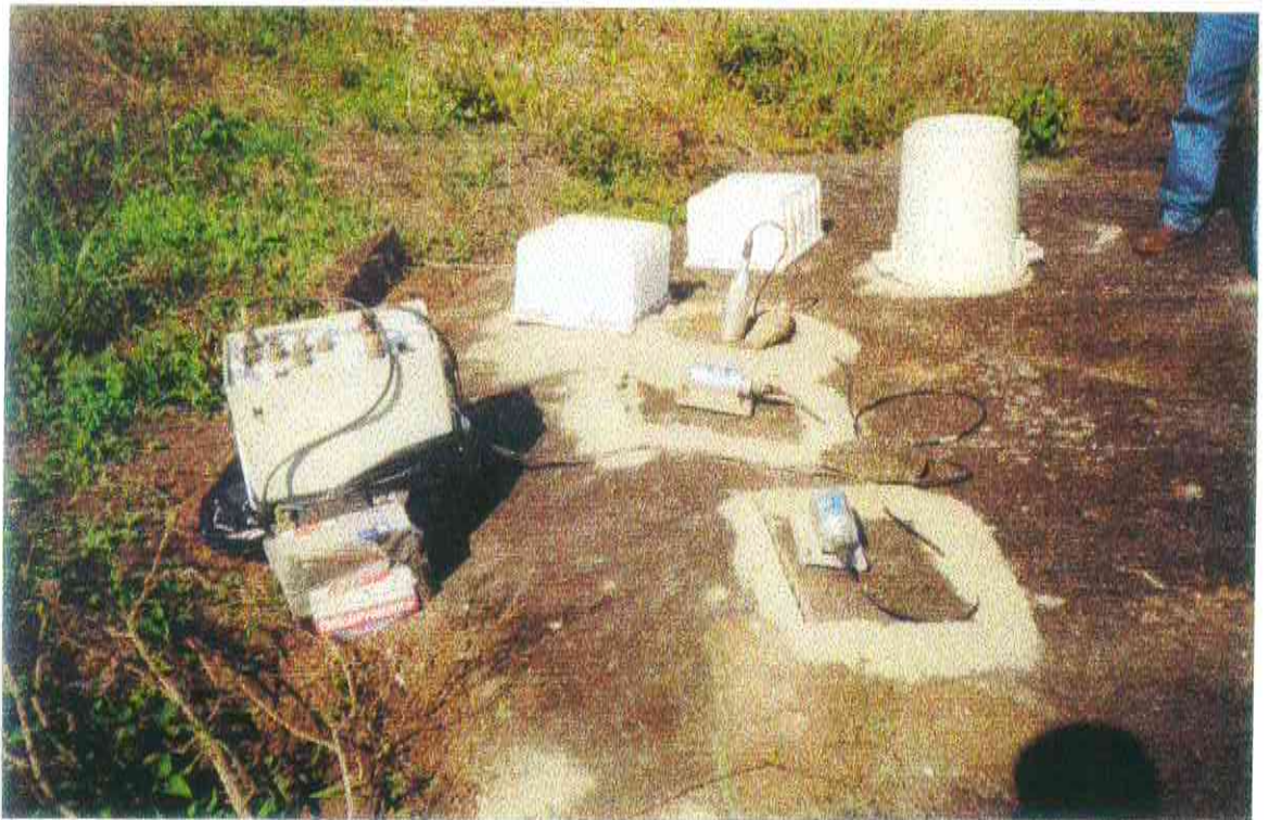
Foto 11 - Sismógrafo digital mostrando os sismômetro L4-C e o registrador SSR-1
