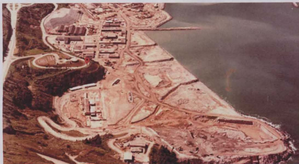
Figura 2.12. Pedra de Itaorninha retaludada com Centro de Informações e aterro completo em 1982.
